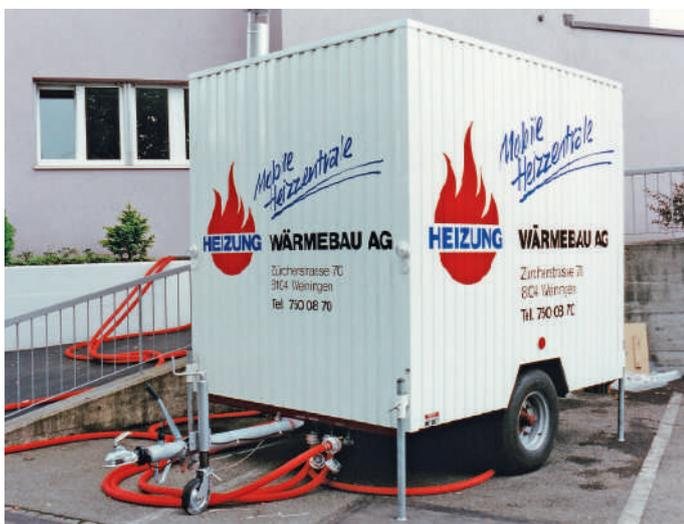
Die erste mobile Heiz- und Warmwasserzentrale wurde 1990 gebaut: Anschlüsse und Kupplungen mit Feuerwehrschräuchen.
